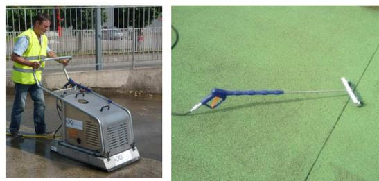
Une pression de service réglable jusqu'à 300 bars et un débit de 15l/min.
